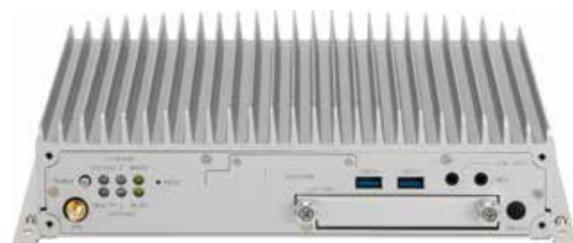
**車** 載用 PC は、広い温度範囲や堅牢な造りのため、車載にとどまらず、厳しい条件下での多方面のソリューションに適しています。また、移動体においても、車載用 PoE ハブを介してカメラを追加することも可能です。NEXCOM スマート監視ソリューションによる静止画転送機能を使用すれば、複数台のカメラ画像を、LTE で無理なく通信できます。
