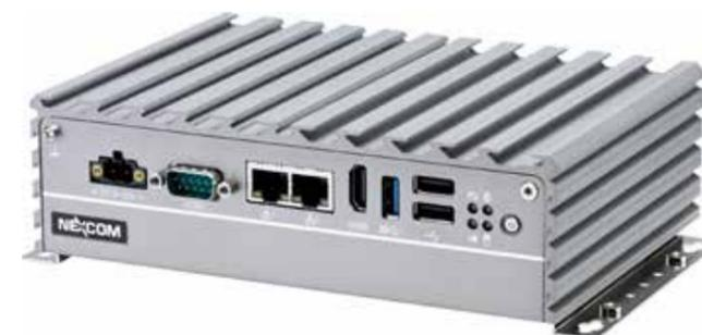
NISE105 をベースに CPU を Celeron J1900 に変更し、従来の約4倍程度高速化を実現しました。内部構造の簡素化によりコストダウンを実現した広範囲で採用いただける小型ファンレス PC のバリューモデルです。
